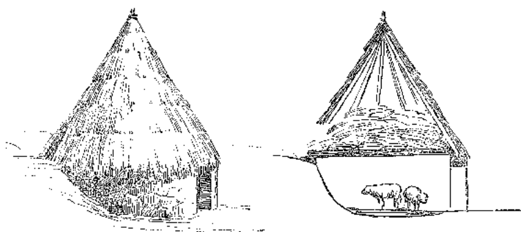
Fig. 4 — Construção cilíndrico-cónica de Prime (Fragozela, Viseu), e o perfil da mesma construção, onde se vê a porta do curral em baixo, e a entrada do palheiro aberta no próprio telhado.
